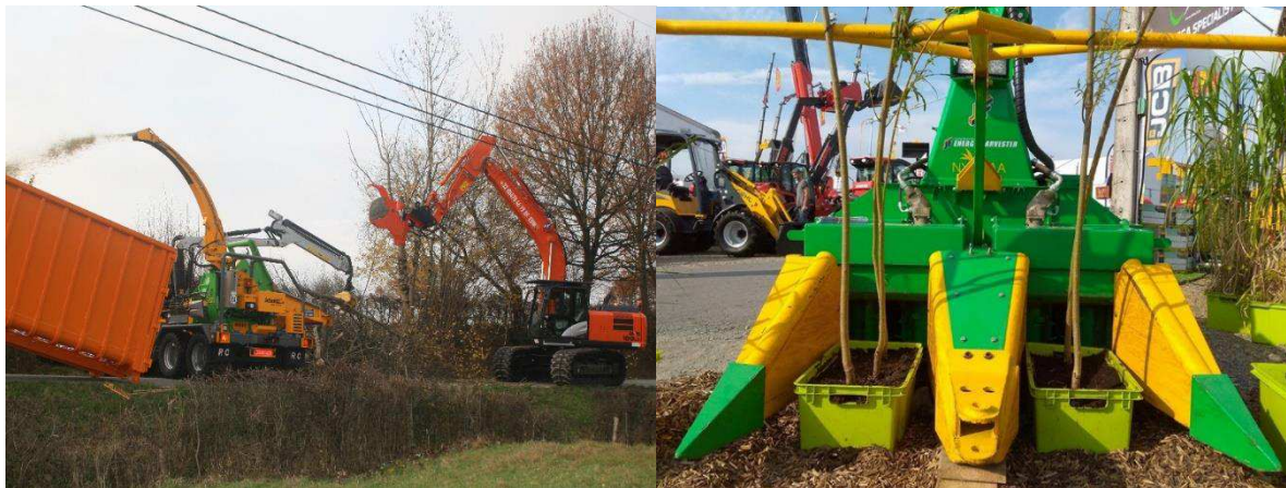
Figure 6 : à gauche : tête de récolte pour TCR de peupliers (sur pelleuse) + broyeur. À droite : Tête de récolte pour le TTCR de saule
