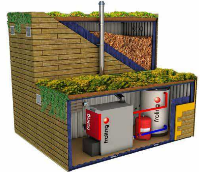
LA CHAUFFERIE EXTERNE
