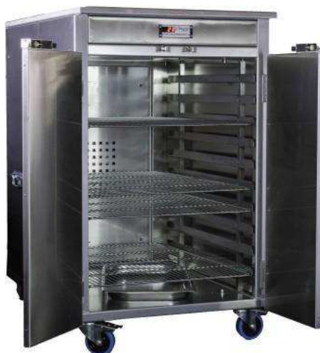
Figure 45 : Etuve, qui a servi à simuler le séchage technique des plaquettes de bois.
