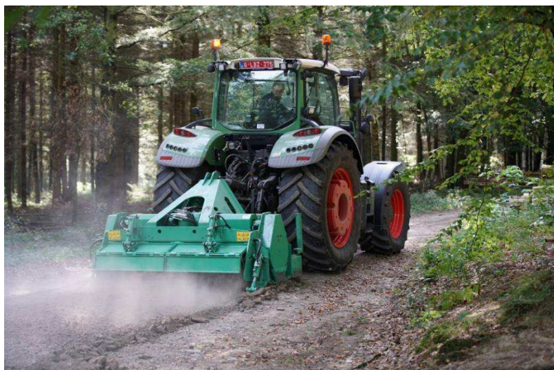
Figure 32 : Démonstration de fraisage de chemins forestiers.
