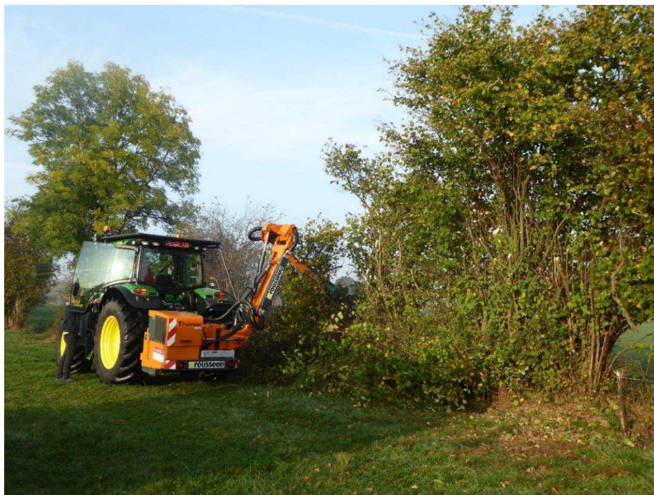
Figure 40 : Weekend du bois 2018 : Rabattage d'une haute haie (Eunis FA.4) avec un lamier d'élague (LEM) à scies, modèle Thénor.
